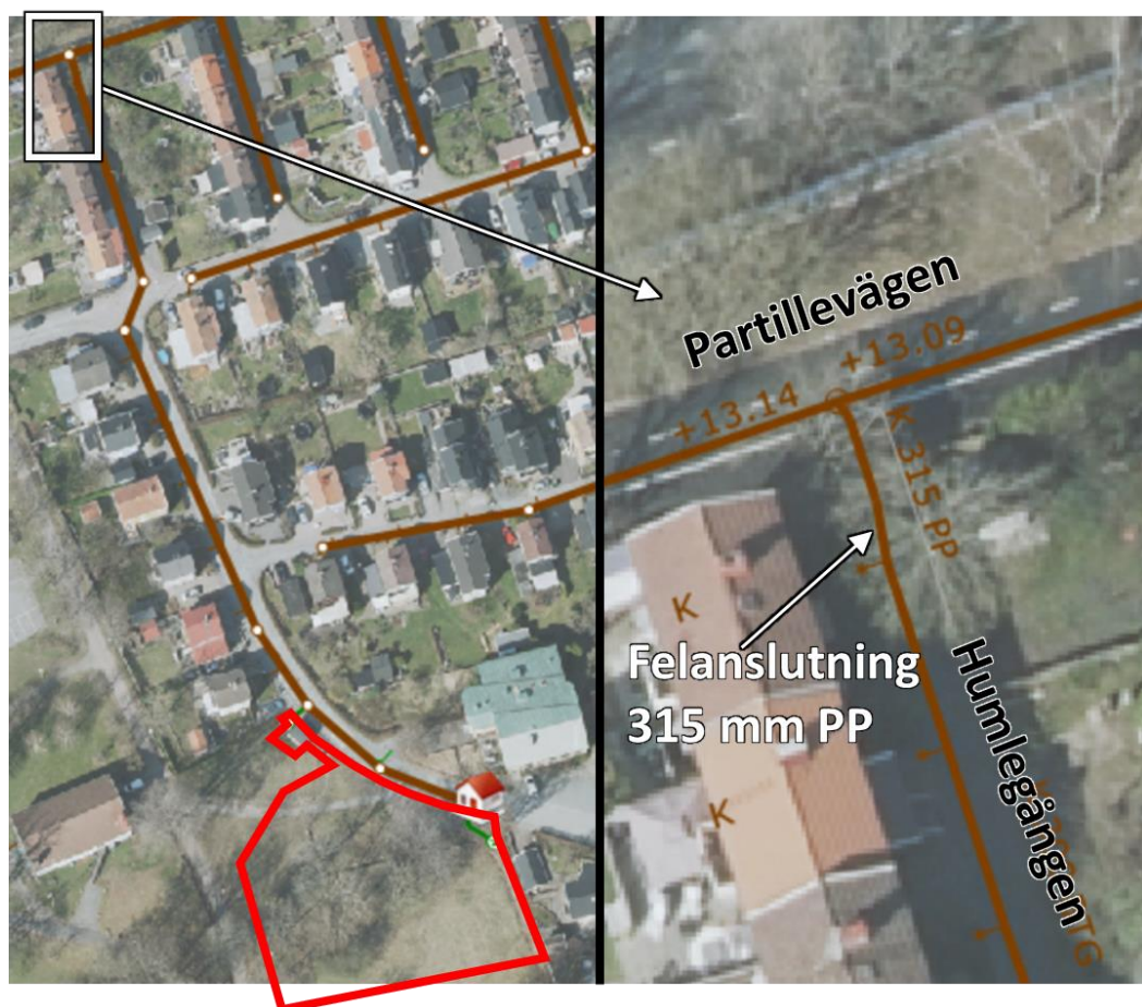
Figur 14. Översikt ledningssystem nedströms planområdet, markerat i rött, samt inzoomning på ledningssträcka där 315 PP har blivit felansluten till befintlig 300 BTG.
